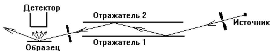
Рис.12. Схема флуоресцентного прибора, использующего эффект полного внешнего отражения.
