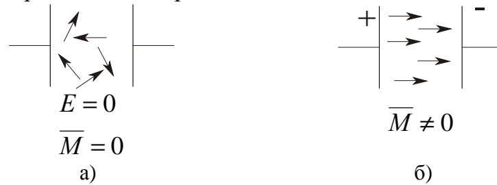
Рис. 8. Полярный диэлектрик в отсутствии поля (а), и при приложении внешнего поля (б)
