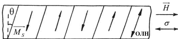
Рис. 30. Поворот намагниченности в ферромагнитной полоске с осью легкого намагничивания, ориентированной под углом к направлению, перпендикулярному длине полоски
