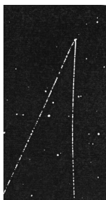
Рис. 36. Изображение доменных границ, полученное методом порошковых фигур Акулова – Биттера
