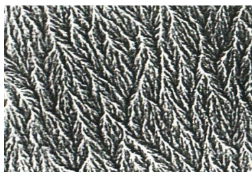
Рис. 45. Электронно-микроскопическое изображение ряби намагниченности, полученное способом дефокусировки
