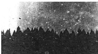
Рис. 39. Изображение магнитной доменной структуры, полученное при помощи меридионального эффекта Керра
