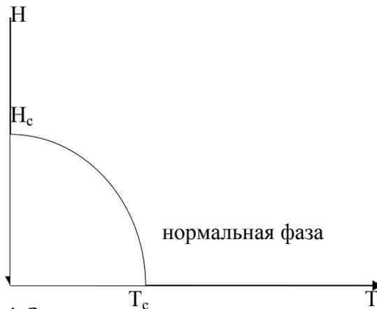
Рис. 4. Зависимость критического поля от температуры
